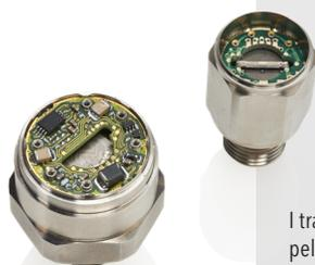
I trasmettitori di pressione Trafag con sensori a pellicola sottile su acciaio e l'elettronica ASIC sono concepiti per offrire la massima resistenza un'elevata precisione anche in caso di forti vibrazioni o di condizioni ambientali avverse.
