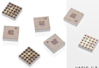
L'ASIC di Trafag è ottimizzato perfettamente per gli elementi sensore proprietari. L'innovativo Mixed Signal Chip con amplificatori ad alte prestazioni permette una capacità di misurazione eccellente.
